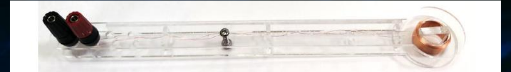
圖四、新式透明線圈桿。線圈匝數 N 見桿上標示，平均直徑約 2.18 cm。
