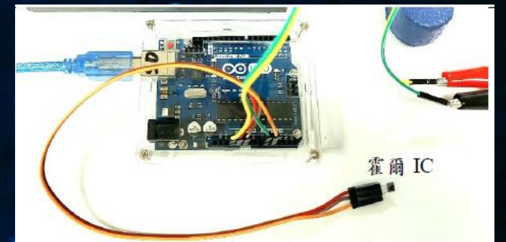
圖三、使用 Arduino 擷取線圈的感應電壓(接到 A0)與霍爾 IC 的輸出電壓(接到 A1)。
