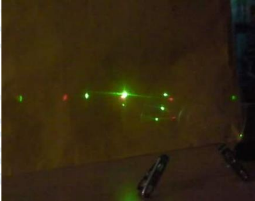
圖 5-5 不同雷射光透過碟片後方產生繞射點。波長較長的光繞射點的距離較大。
