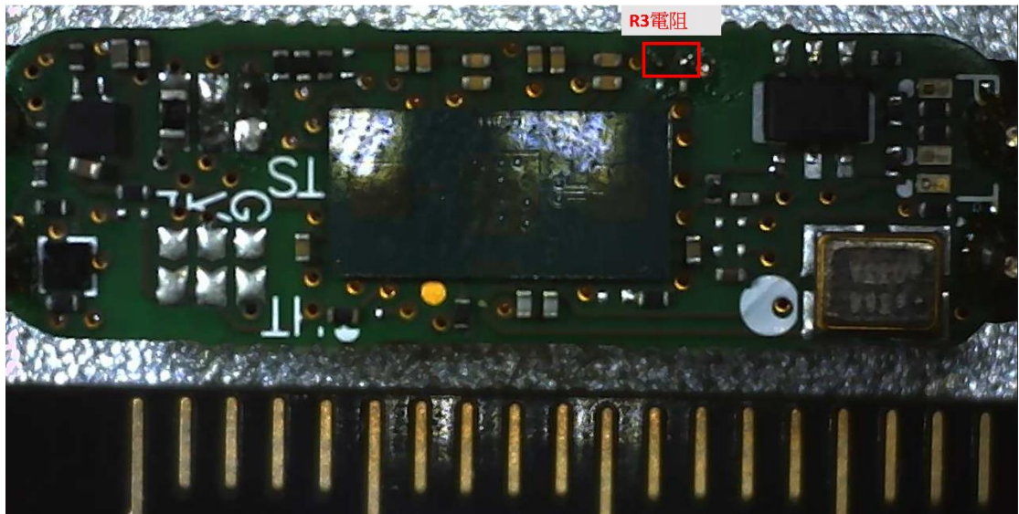
圖 7 解焊後 R3 電阻(1mm/刻度)
