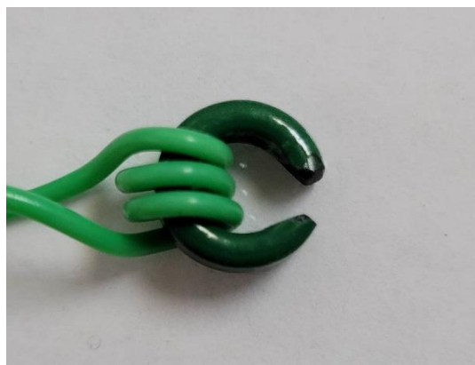
圖二、將單芯線纏繞在磁環上
