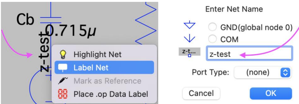
圖 16 節點名稱修改設定為對節點按下右鍵，選擇 Label Net (左)，跳出對話框後填入 z-test (右)。
