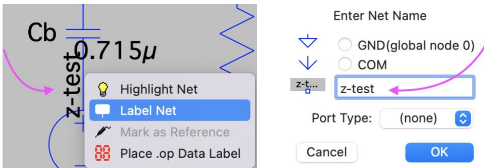
圖 16 節點名稱修改設定為對節點按下右鍵，選擇 Label Net (左)，跳出對話框後填入 z-test (右)。
